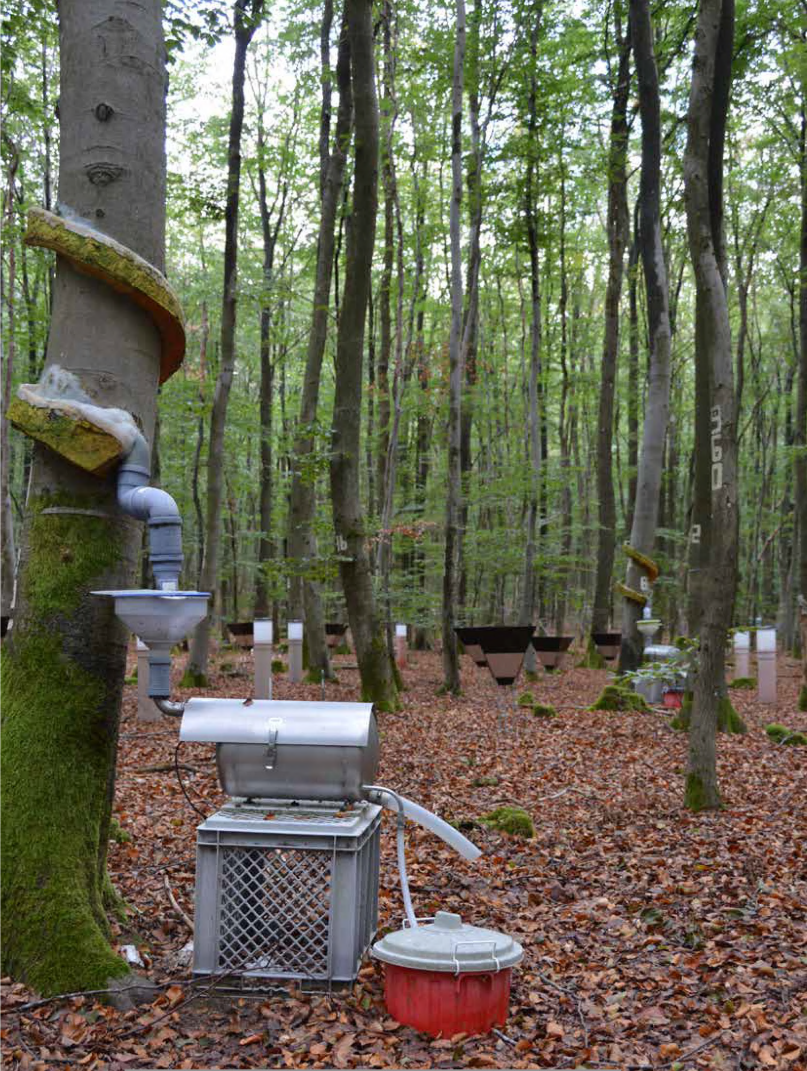
Blick in die Umweltkontrollstation Buche, Merzalben. Im Vordergrund Stammabflussmessung, im Hintergrund Depositions- und Streufallsammler
