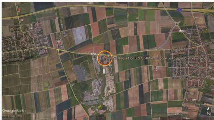
Bild 12: Gefährdungsradien für den AEGL-2-Wert (10 min) im Abstand von 124 m (roter Kreis) und 135 m (gelber Kreis) in Abhängigkeit von der Schützeit (30 s bzw. 50 s)
