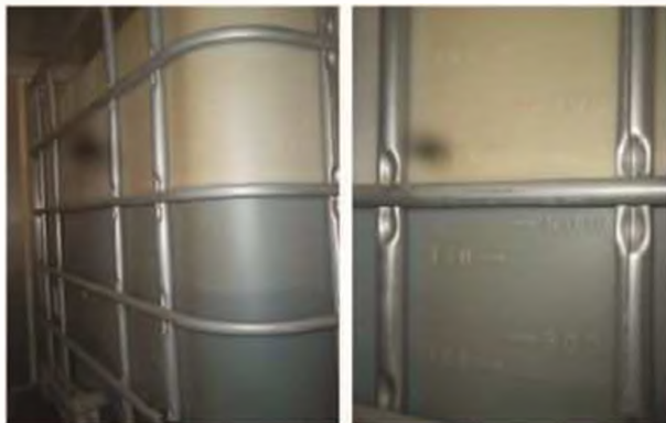
Bild 8 Foto (SGS) des Unfall-IBC vom 13.08.19 – Füllmenge und Erkennbarkeit von Schlämme- und Flüssigphase
